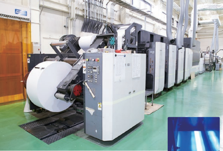
LED-UV高速両面8色輪転印刷機と紫外線を照射するLEDランプ
