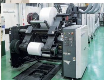
高速両面8色 小森B3輪転印刷機 (油性・LED-UV兼用機)
