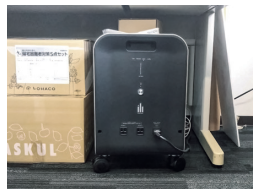
セコム蓄電池
